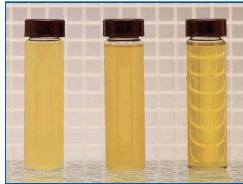
Eliminación del agua libre en aceite de turbina típico: el aspecto brillante y transparente indica la ausencia de agua libre
